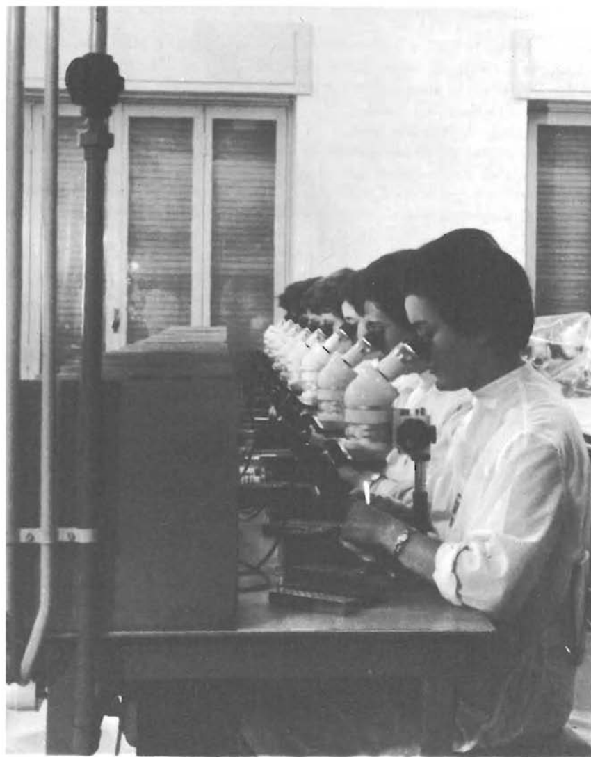
Posizionatura di transistor per alta frequenza (Fabbrica Semiconduttori Philips - Monza)
