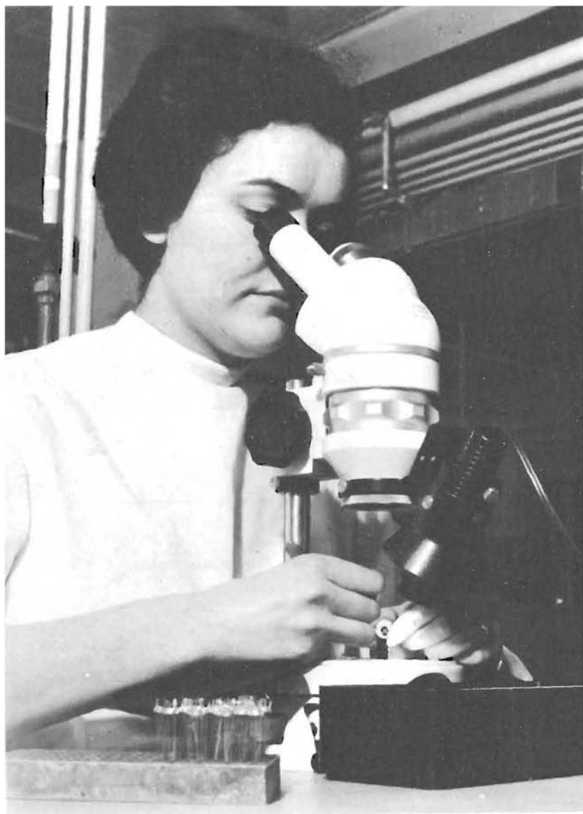
Posizionatura di transistor per alta frequenza (Fabbrica Semiconduttori Philips - Monza)
