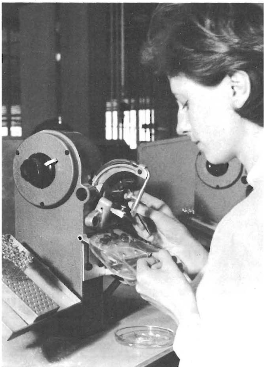
Saldatrice a temporizzatore elettronico (Fabbrica Semiconduttori Philips - Monza)
