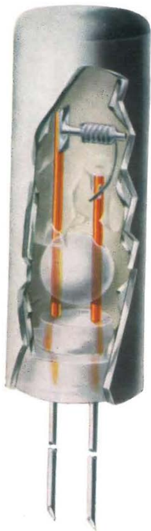
Diodo Zener al silicio ottenuto con il processo di lega.
