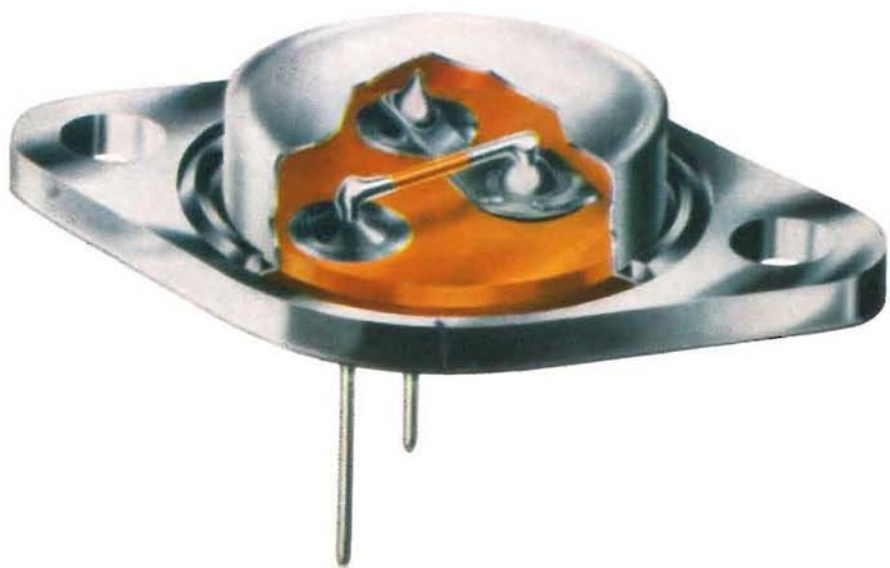
Transistor al germanio ottenuto con processo di lega, per stadi finali e di potenza.
