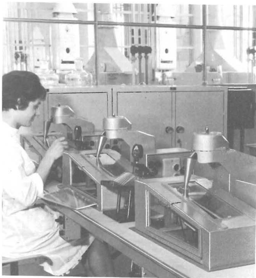
Selezione dello spessore dei cristalli di germanio (Fabbrica Semiconduttori Philips - Monza)
