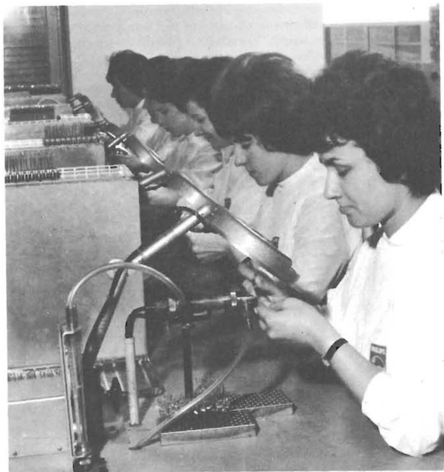
Aggraffatura dei transistor di bassa frequenza (Fabbrica Semiconduttori Philips - Monza)
