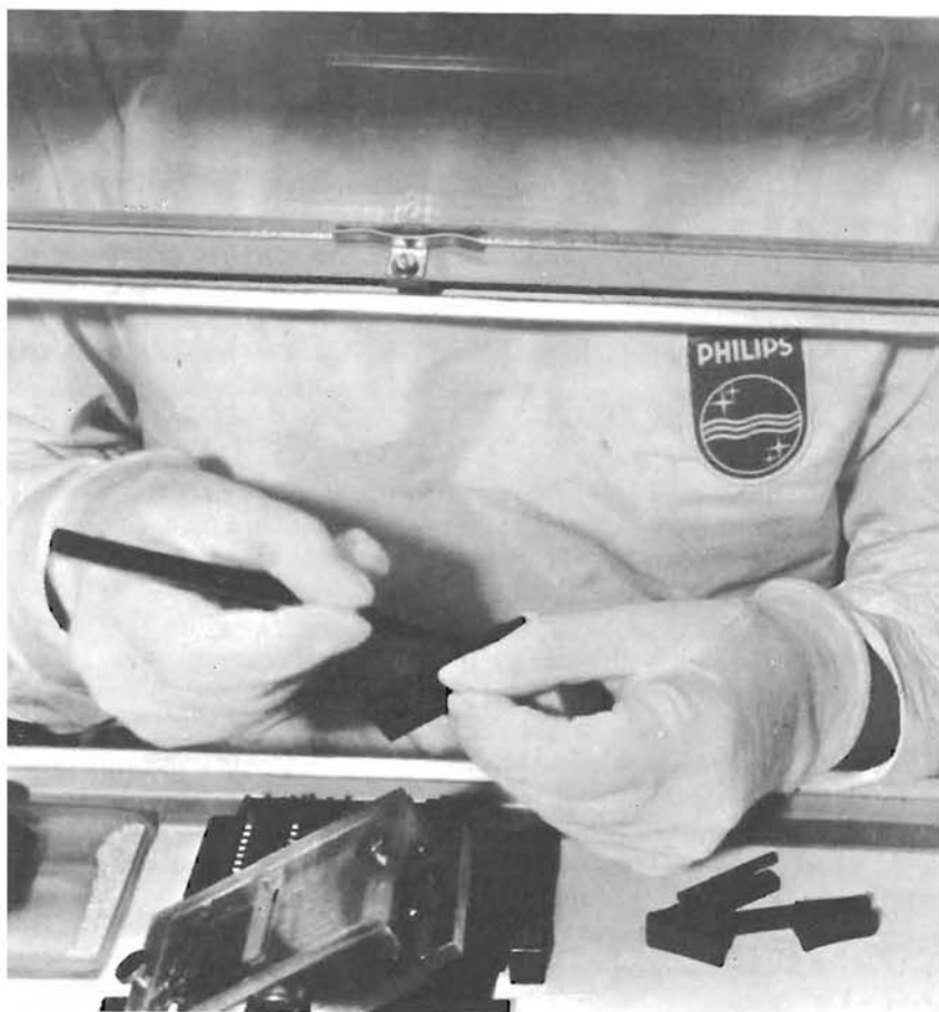
Carico della navicella per il processo di lega e di un transistor Philips (Fabbrica Semiconduttori Philips - Monza)
