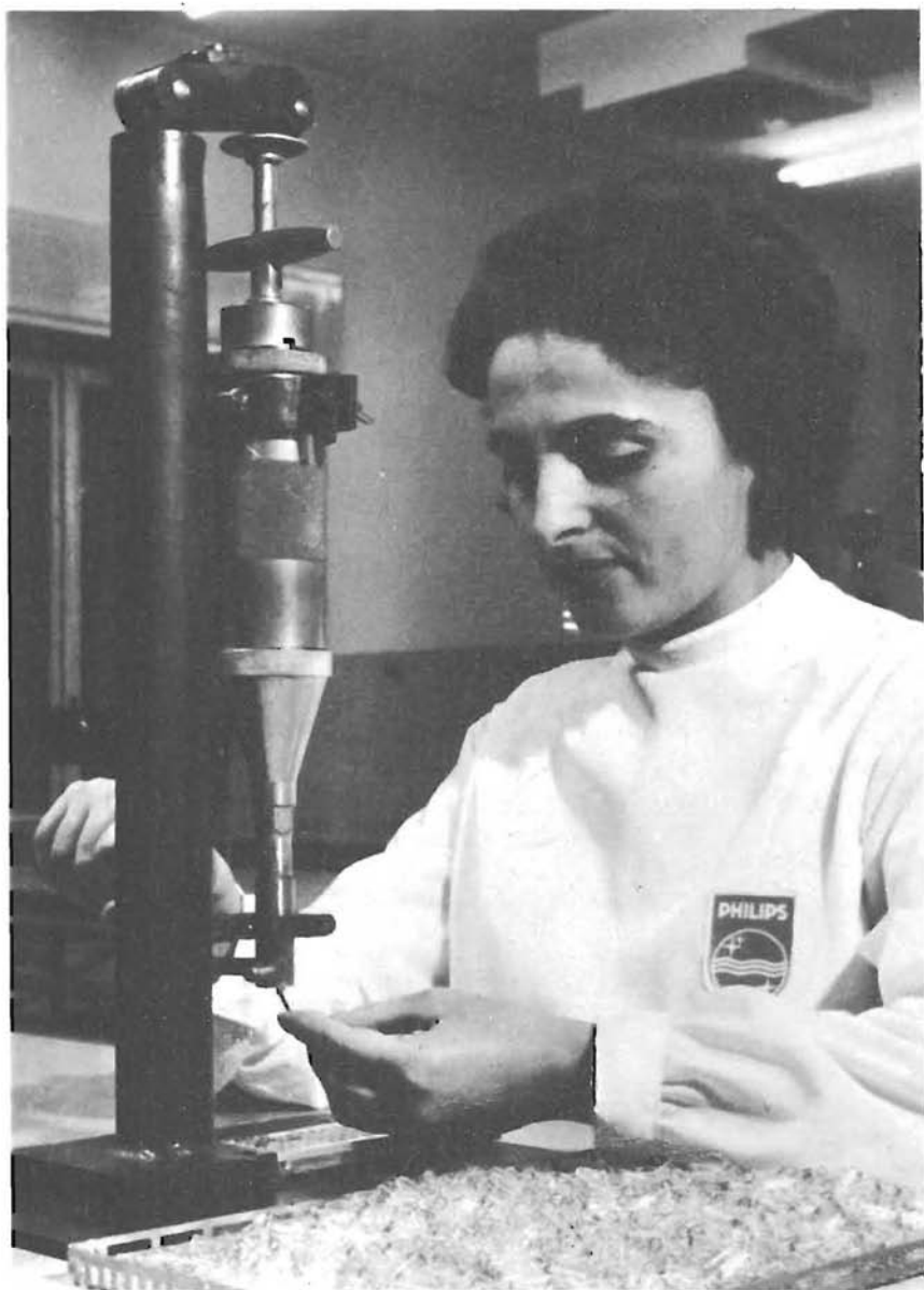
Preparazione dei palloncini di vetro per un determinato tipo di transistor (Fabbrica Semiconduttori Philips - Monza)
