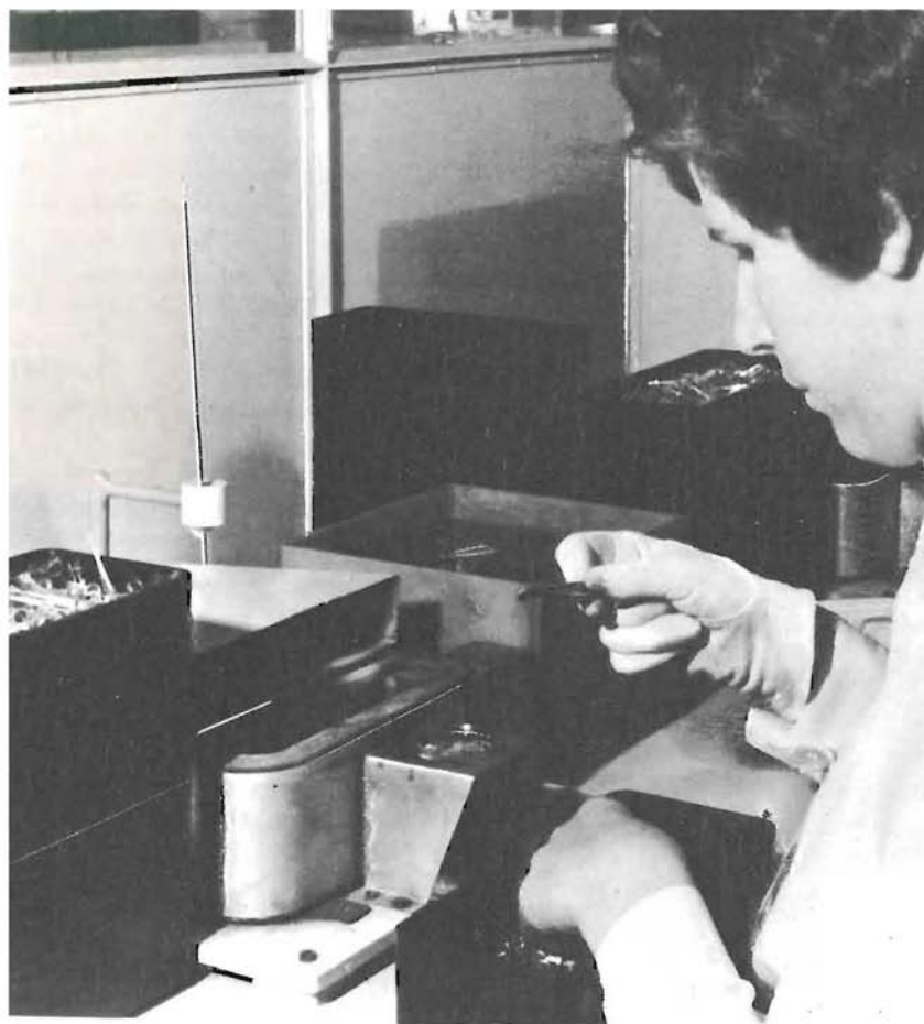
Stagnatura dei reofori (Fabbrica Semiconduttori Philips - Monza)
