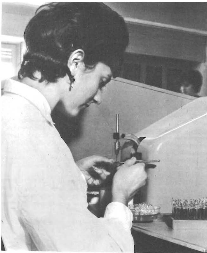
Montaggio delle connessioni dei transistor di bassa frequenza (Fabbrica Semiconduttori Philips - Monza)
