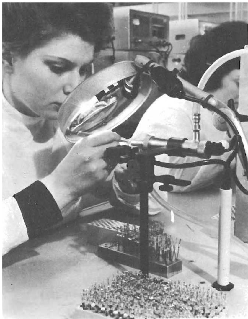
Aggraffatura dei transistor Philips di bassa frequenza (Fabbrica Semiconduttori Philips - Monza)
