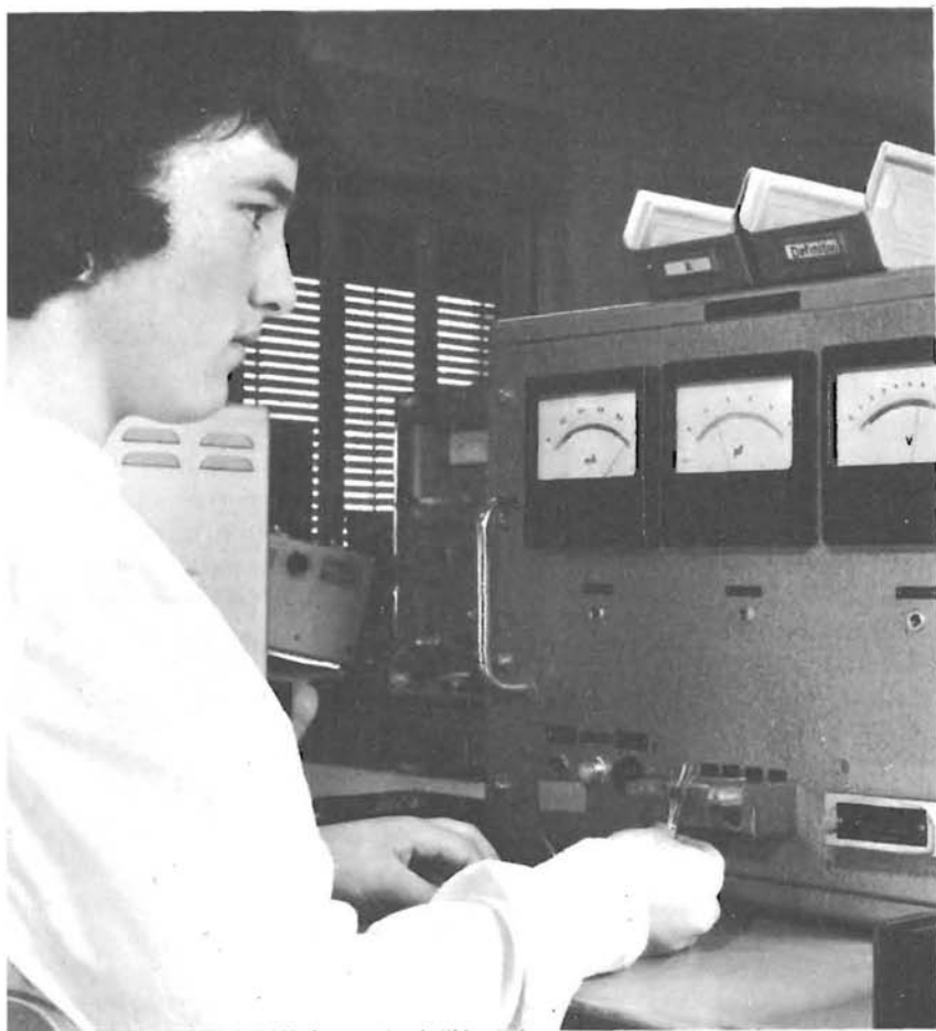
Misura della capacità di collettore di un transistor Philips (Fabbrica Semiconduttori Philips - Monza)
